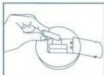
( 1 ) Установка батарей: в передатчик невидимого забора в соответствии с указателями полюсов (+) и (-) установите 3 щелочных батареи типа AA.
