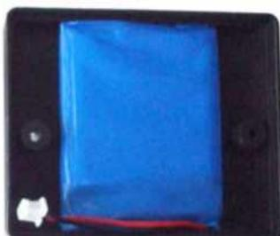
5.1.4 Подключите батарею, как показано ниже, и закройте заднюю крышку, затянув **ВИНТЫ**.
