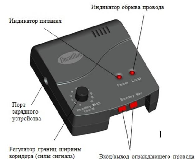
**Регулятор ширины границ воздействия (силы сигнала):** позволяет установить ширину запрещенной для питомца зоны, где будет воздействовать комбинация из предупреждений вибрацией и электро-статической коррекции.
